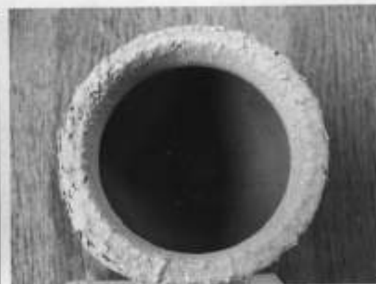
Модел печен на 825°C – спољашна страна и унутрашњост
