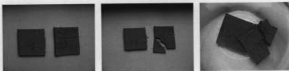
Узорци бр. 4 и IV, температура печења 735°C
