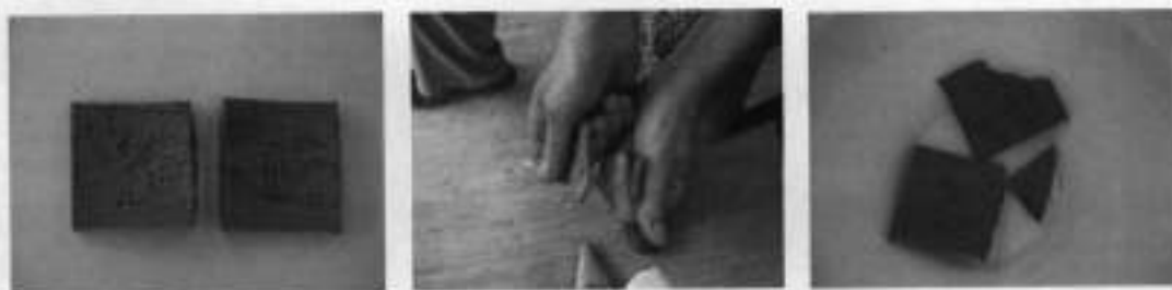
Узорци бр. 3 и III, температура печења 700°C
