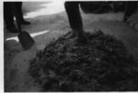
Гажење глине и самлевеног калцита
