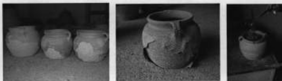
Љуспање лонаца услед печења на температури већој од оптималне
