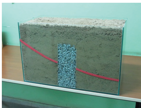
Модел бетонских елемената са испуном који пресецају клизну површ
